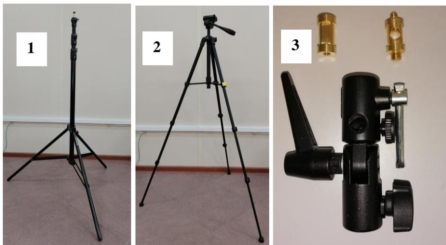
Рисунок 4.4 – Внешний вид стойки (1), штатива (2) и поворотной головки (3)\*
